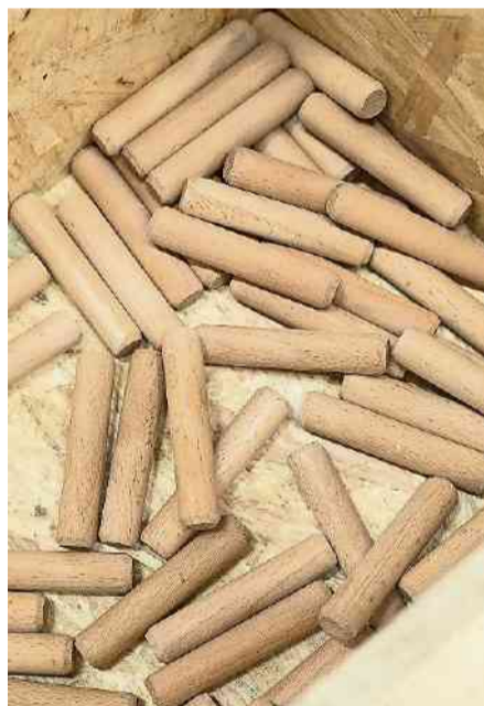
Soll Fachleute beeindrucken: Die metallösen Verbindungselemente bestehen auch aus Buchenholz.
